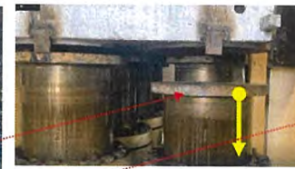
กระบอกสูบสูญเสียดันและเคลื่อนตัวลงเมื่อบีบไฮดรอลิกหยุดทำงาน (ภาพแสดงสถานะที่แรงดันไฮดรอลิกหยุดทำงาน)
